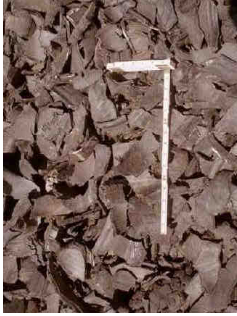
Rys.1. Materiał pochodzący z recyklingu opon, Czipsy gumowe (10-50 mm)
